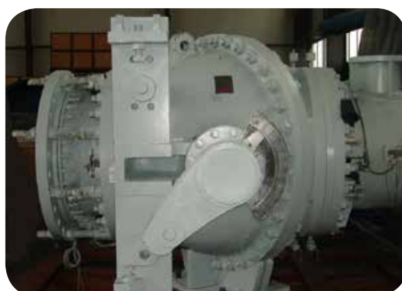
Montaje de la válvula de bola
