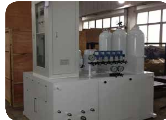
Acumulador de nitrógeno HPU
