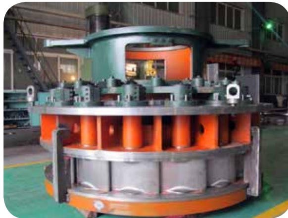
Distribuidor de turbina
