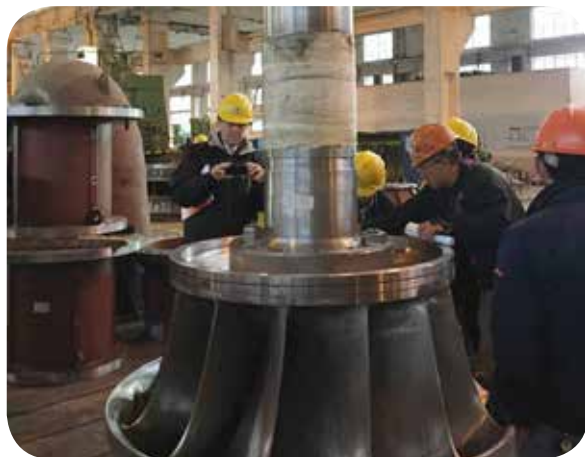
Pruebas de aceptación en taller de ITATA HPP
