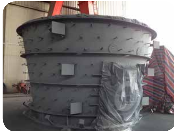
Cono de turbina
