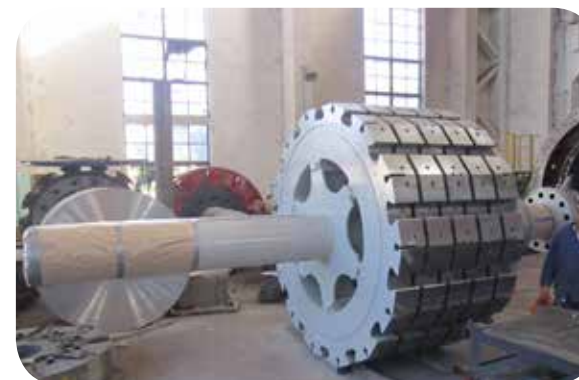
Yugo de rotor del generador
