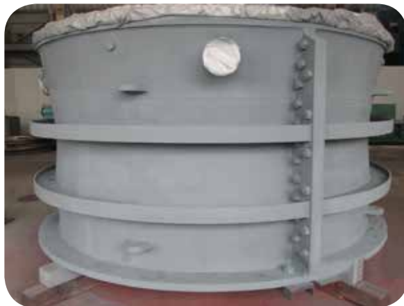
Cámara del corredor de Kaplan turbina
