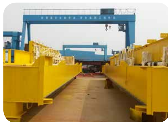
Viga principal de la grúa
